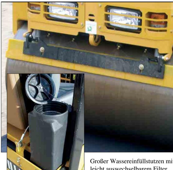
Großer Wassereinfüllstutzen mit leicht auswechselbarem Filter
