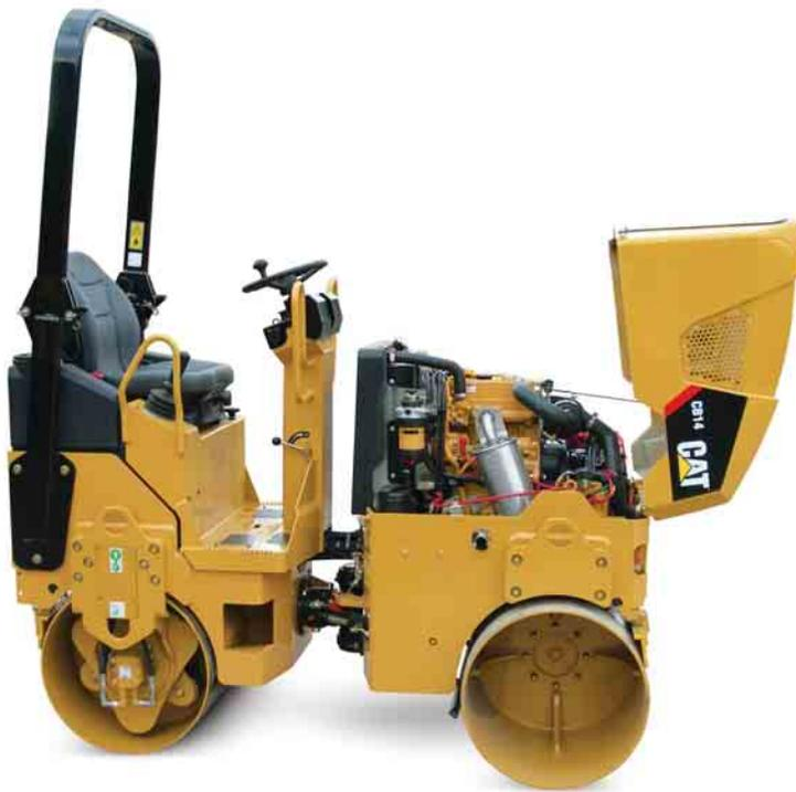
**Motorhaube.** Die hochschwenkbare, arretierbare Motorhaube gibt Dieselmotor und Nebenaggregate frei.
