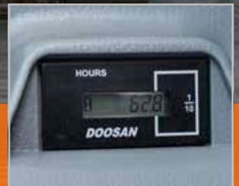
Betriebsstundenzähler (vom Boden aus ablesbar)
